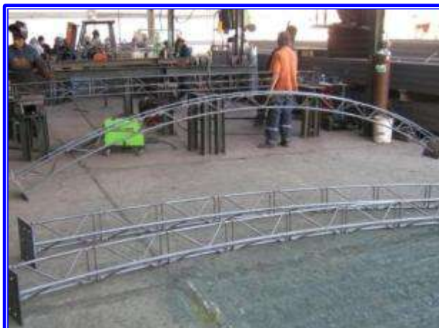
Fabricación de Cimbras – Planta FORMIN
